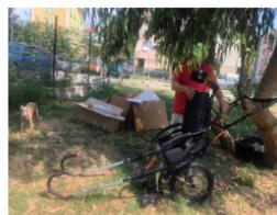
La Joelette tolta dal suo imballaggio si presenta già pre-assemblata ad eccezione dei maniglioni che fanno parte della struttura, del poggiatesta e del poggiapiedi. Elementi che successivamente rimarranno montati.
